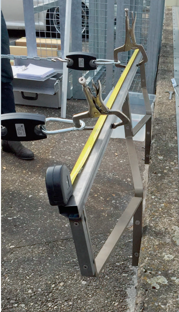
Bild 6: Verformungen (gegen links) des Geländeroberteils bei der Bauteilprüfung. Figure 6 : Déformations (vers la gauche) de la partie supérieure de la balustrade lors du test des éléments de construction
